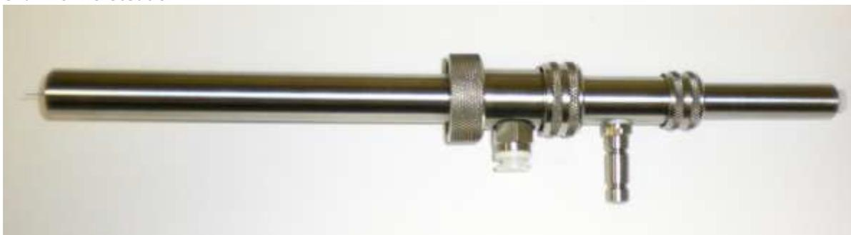
Ensamblaje de la boquilla de 0.5 mm, y de los chorros internos y externos en la foto.
