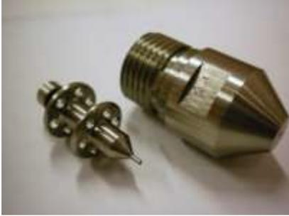
El extremo de la boquilla del cuerpo del atomizador, que muestra asomando la aguja del desbloqueador.
